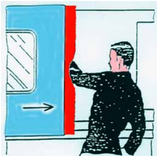
Kuva 16. Konevoimalla sulkeutuvasta suojuksesta aiheutuvaa riskiä vähennetään tuntoreunalla.
