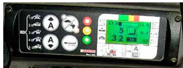
Kuva 25. Kurottajassa oleva kaatumismomenttia valvova laite varoittaa raja-arvon lähestymisestä. Jos raja ylitetään, liikkeet pysähtyvät. Sen jälkeen vain kaatumismomenttia pienentävät liikkeet (esim. puomia sisään päin) ovat mahdollisia.
