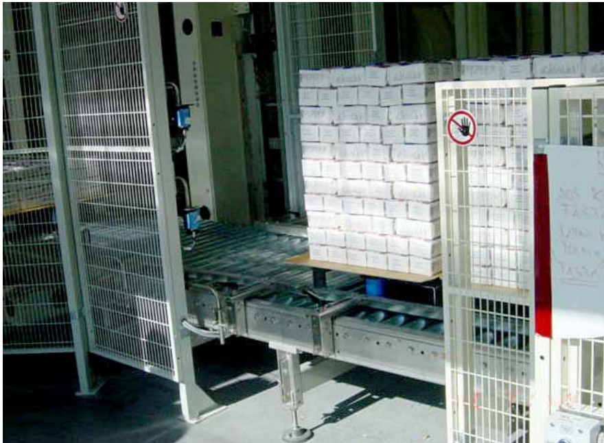
Kuva 2. VÄÄRIN. Aitaan jätetty aukko tekee mahdolliseksi automaattisen konelinjan vaarakohtiin pääsemisen minkään turvalaitteen havaitsematta. Toimitus on siten selvästi säädösten vastainen. Puuttuvaa aitaa ei voi korvata kieltoimerkillä.
