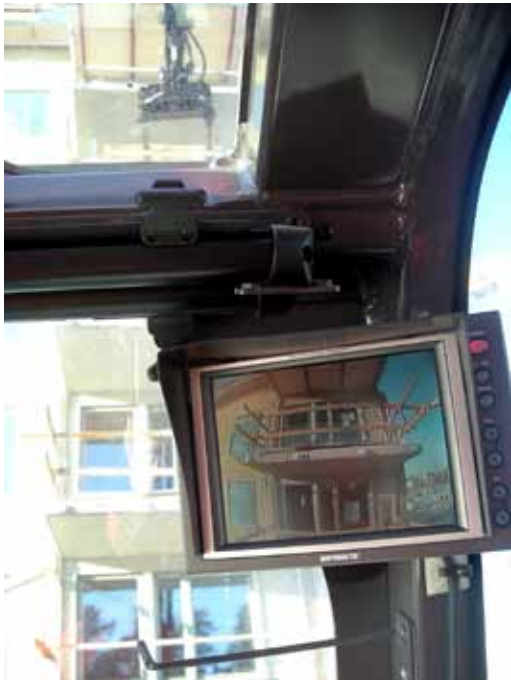
Kuva 37. Kun kurottajassa on kamera puomin päässä, koneen käyttäjä näkee tarkasti mihin kuormaa ollaan jättämässä tai mistä sitä ollaan ottamassa. Kun kurottaja lähtee peruuttamaan, näyttöön vaihtuu taaksepäin suunnatun toisen kameran kuva.
