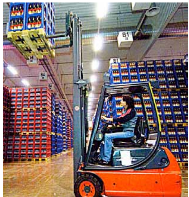
Kuva 39. Trukissa on putoavilta esineiltä suojaava turvakatos.
