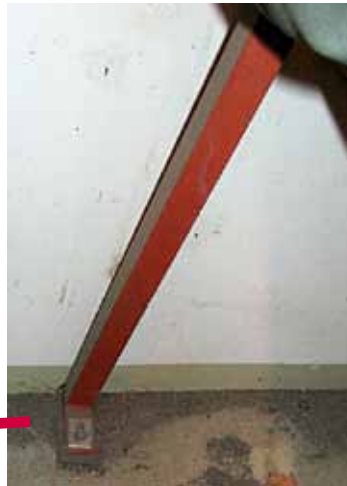
Kuva 8. Penkkihioma- koneen teline on kiinnitetty tukevasti lattiaan.
