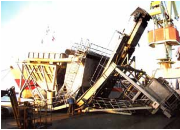
Kuva 3. Esimerkkejä riittämättömän lujuuden aiheuttamista tapaturmista.
