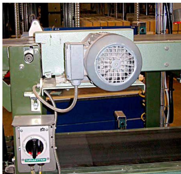
Kuva 31. Tässä syötönerotuskytkimen ja erotettavan koneen (moottorin) yhteys on selvä sijainnin perus- teella.
