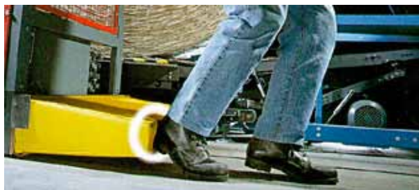
Kuva 36. Tuntopuskuria voidaan käyttää törmäyksen seurausten lieventämiseen.
